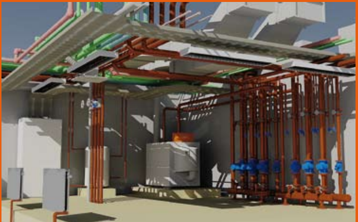
Technische ruimte met verdelers en leidingen.
